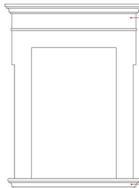
Cornice di coronamento superiore realizzata a "finta pietra" con elementi in cotto di vario spessore e finitura ad intonaco
