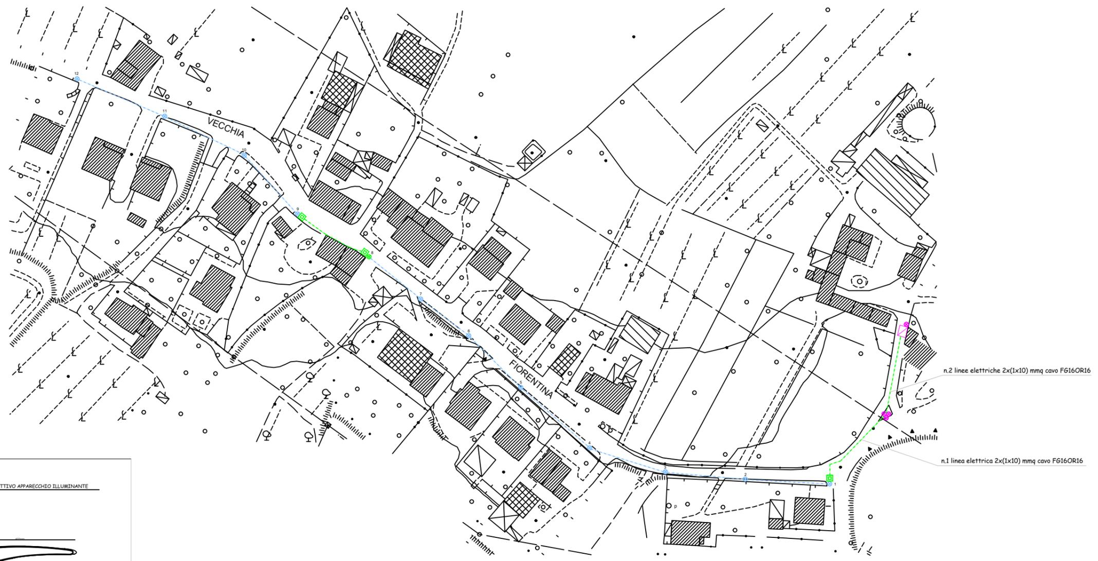
n.2 linee elettriche 2x(1x10) mmq cavo FG16OR16
