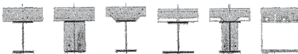
Figura 23.1. Tipologie di sezione composte per travi in acciaio con soletta collaborante
